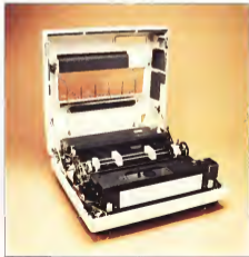
La stampa con apertura. Nella foto si vede il meccanismo di stampa, il grande sensore del coperchio. Nella parte anteriore, si osserva il connettore di collegamento al computer e il piedistallo di raccolta.
